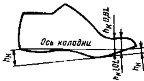
Рис. 4.6. Схема измерения высоты подъема пятоной и носочной частей колодки
