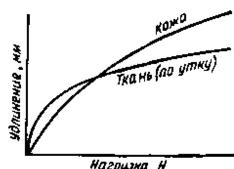
Рис. 22.4. Диаграмма относительной деформации кожи и ткани
