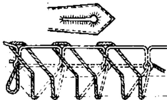
Рис. 19.11. Схема обметочного шва
