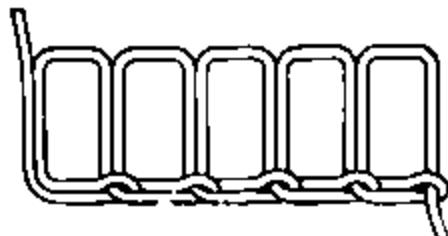
Рис. 19.2. Однониточный стежок наружного переплетения
