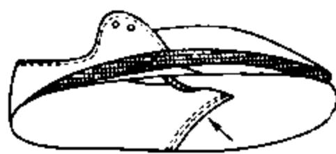
Рис. 21.18. Пристрачивание подкладки берцев к подкладке союзки
