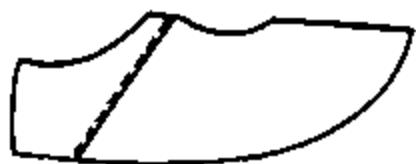
Рис. 21.12. Пристрачивание кожаной подкладки полуботинка к текстильному подкладке
