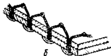
ной (рис. 19.8 б) с прокладкой тесьмы или настрачиванием ремня. Тачной шов задних краев берцев (обычно в туфлях и полуботинках) в верхней части укрепляют закрепкой различного вида.
