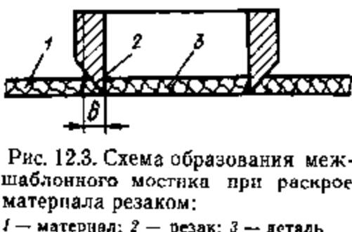
Рис. 12.3. Схема образования межшаблонного мостика при раскroе материала резаком:
