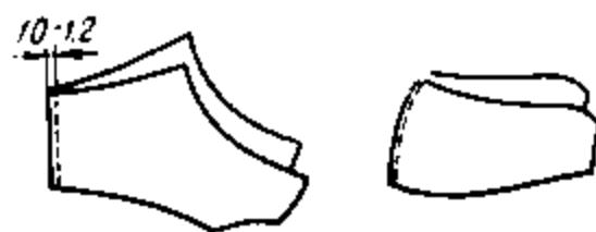
Рис. 21.2. Скрепление задних краев берцев и задников прямым тачным швом
